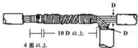
圖一五~七 絞線加紮線之分歧連接法(一)
