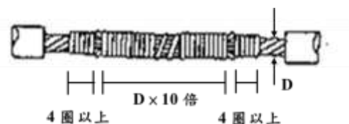
圖一五~四 絞線加紮線之延長連接法
