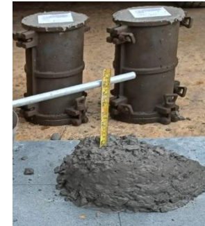
RC基礎台坍塌度
