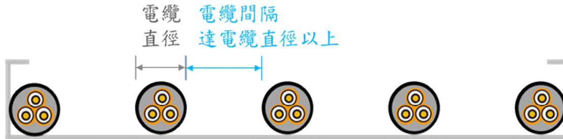
多芯電纜單一層敷設於無蓋板之電纜架
